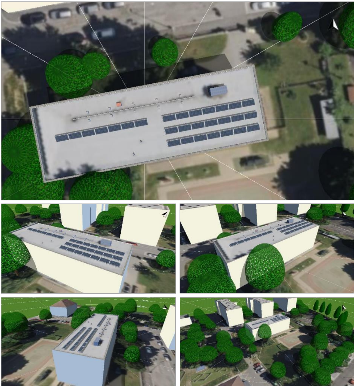
Obrázek 64 Vizualizace střešní FVE na objektu MŠ Jílkova Zdroj: vlastní zpracování pomocí simulačního softwaru
